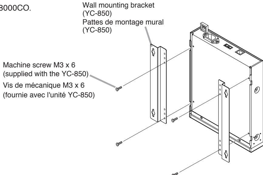
L'unité N-8000CO peut être montée au mur à l'aide d'une patte de montage mural YC-850.
