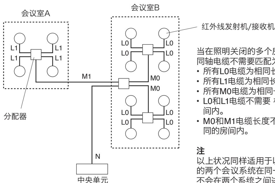
当在照明关闭的多个房间安装时, 不同房间使用的同轴电缆不需要匹配为相同长度。
