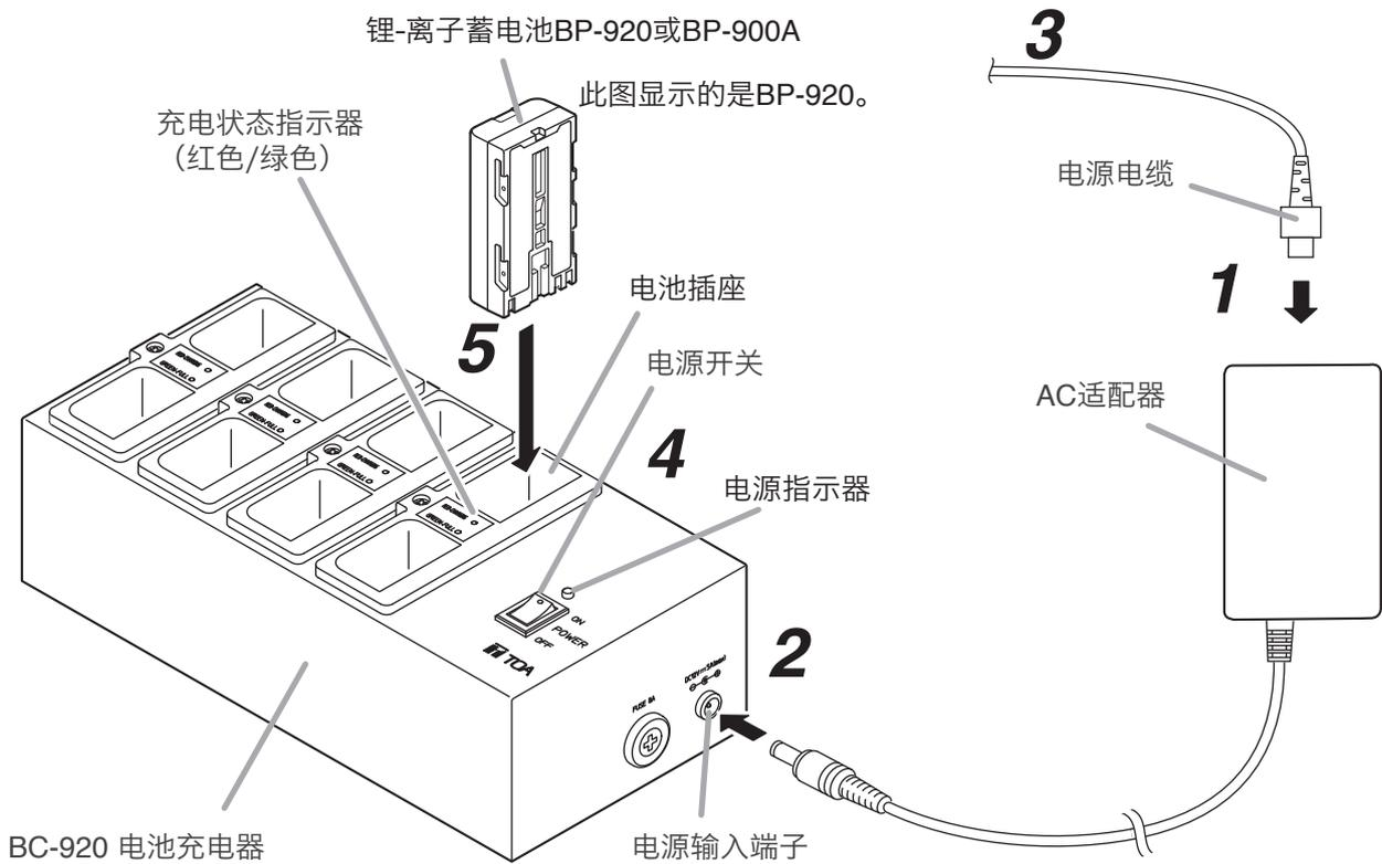
**步骤1.** 将电源电缆连接至AC适配器中。
