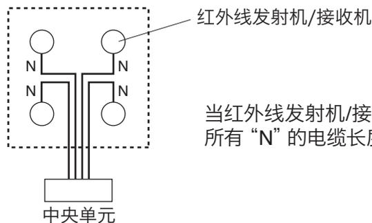
当红外线发射机/接收机单元和中央单元安装在同一空间时所有“N”的电缆长度必须相同。
