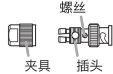
**步骤5.** 将同轴电缆插入夹具中。
