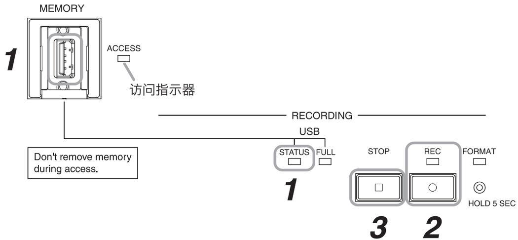
**步骤1.** 将USB存储器插入USB存储器插入端子。
