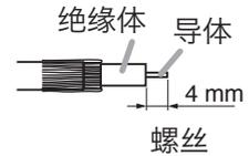
**步骤4.** 如右图所示拆下BNC插头，并拧动插头上的螺丝，使得螺丝部分松开但仍保留在插头上。
