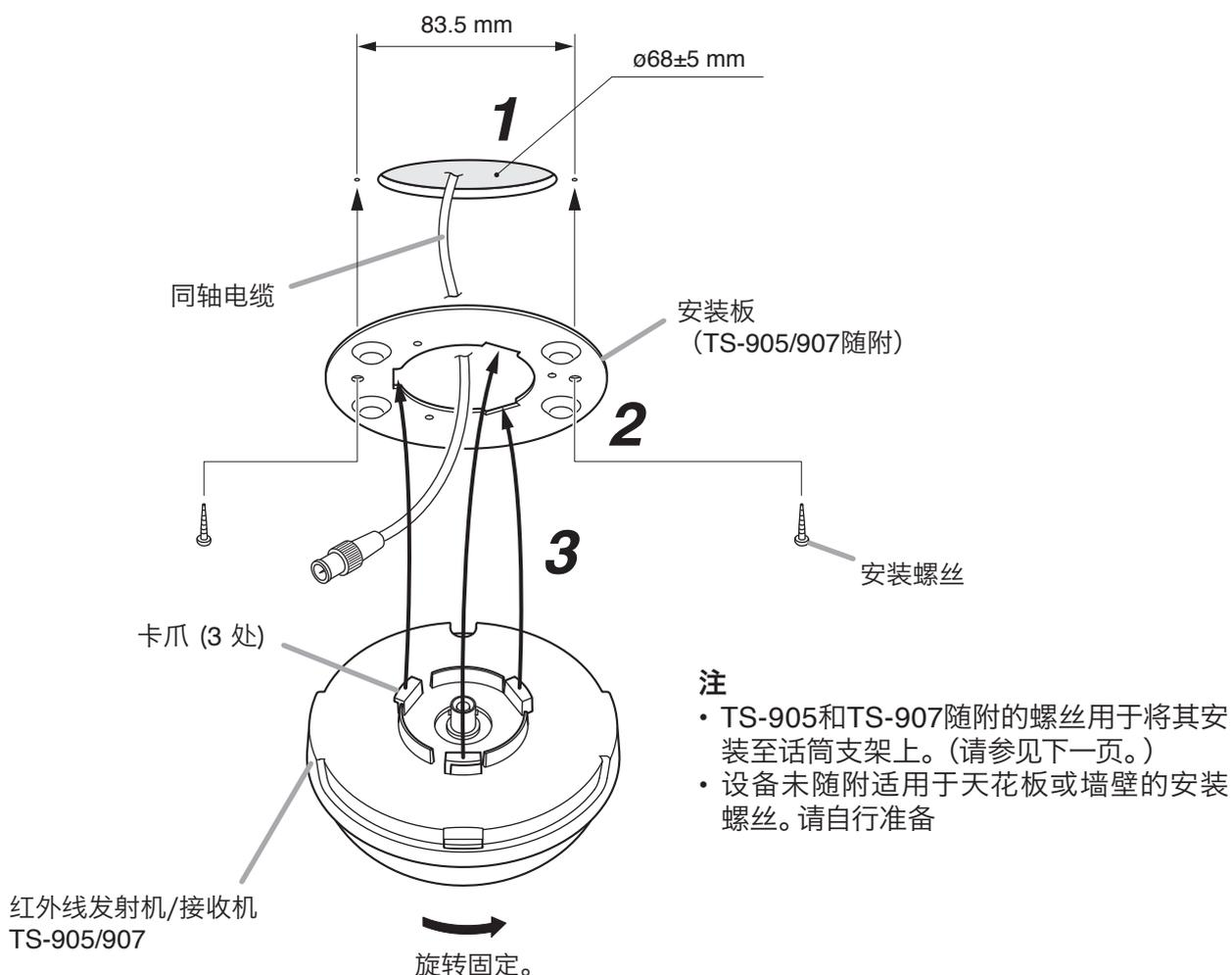
**步骤1.** 在天花板上打68 mm直径的孔。
