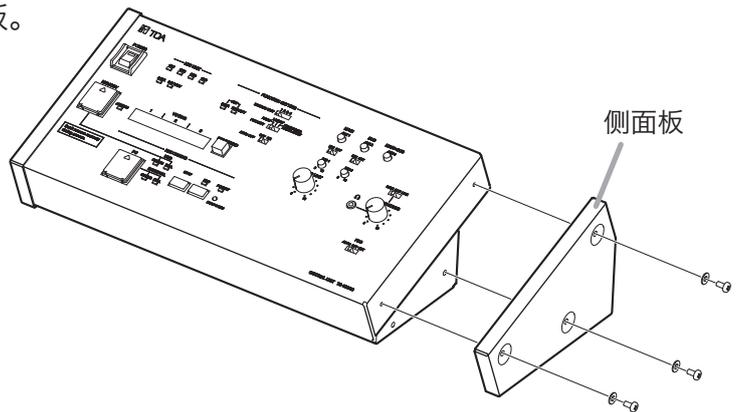
**步骤2.** 将MB-TS920 机架安装架安装至中央单元的两侧。
