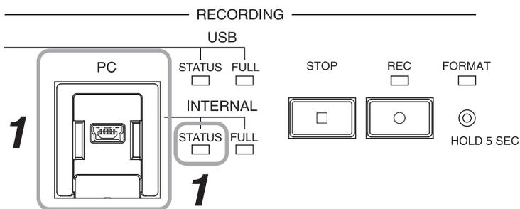
**步骤1.** 将PC连接至PC连接端子。
