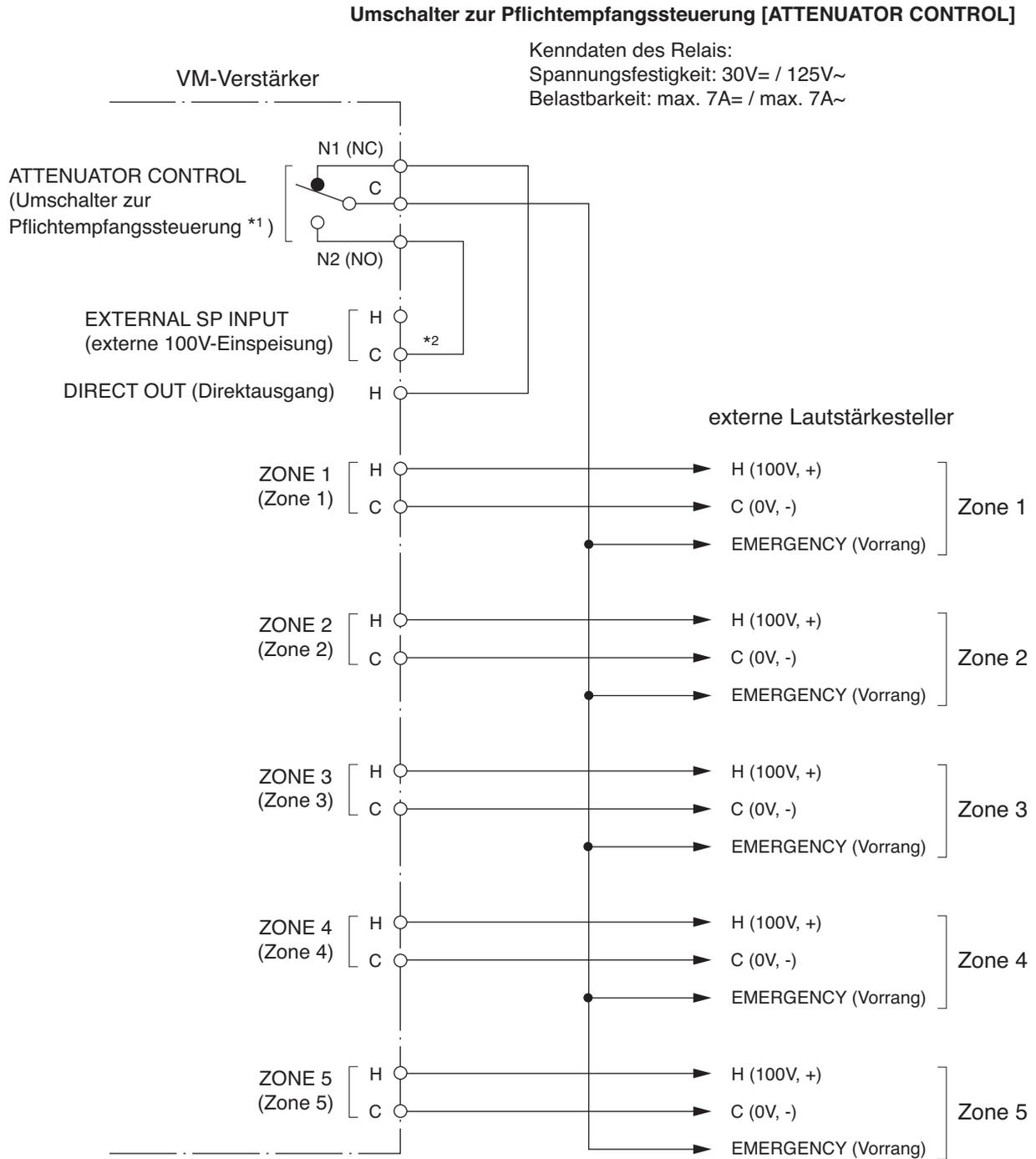
\*1 Die Abbildung zeigt die Stellung des Umschalters, wenn der VM-Verstärker ausgeschaltet ist, eine Sammelruf- oder Notfall-Übertragung erfolgt oder der Steuereingang Verstärkerumschaltung von externen Notfallsystemen aktiviert wurde. Während der Prüfung der Lautsprecherlinien durch die Überwachungskarte SV-200MA befindet sich der Umschalter ebenfalls in dieser Stellung.
