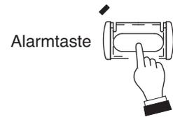
Ein aufgezeichnetes Alarmsignal oder eine Alarmdurchsage wird in alle Zonen übertragen und entsprechend der Voreinstellungen wiederholt \*1. Die Anzeigen für den Notfallbetrieb an der Sprechstelle und am Verstärker leuchten auf.
