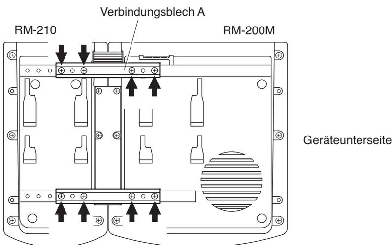
**Anmerkung:** Im Falle einer fehlerhaften oder losen Verbindung zwischen den Geräten lösen Sie alle Schrauben und drehen Sie noch einmal fest.
