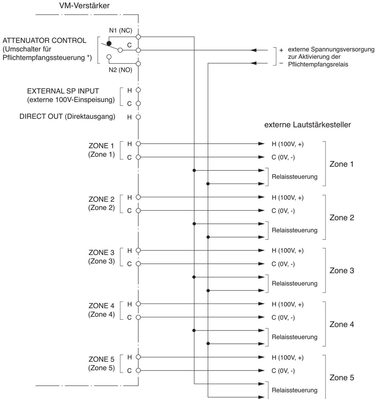
\* Die Abbildung zeigt die Stellung des Umschalters, wenn der VM-Verstärker ausgeschaltet ist, eine Sammelruf- oder Notfall-Übertragung erfolgt oder der Steuereingang Verstärkerumschaltung von externen Notfallsystemen aktiviert wurde. Während der Prüfung der Lautsprecherlinien durch die Überwachungskarte SV-200MA befindet sich der Umschalter ebenfalls in dieser Stellung.
