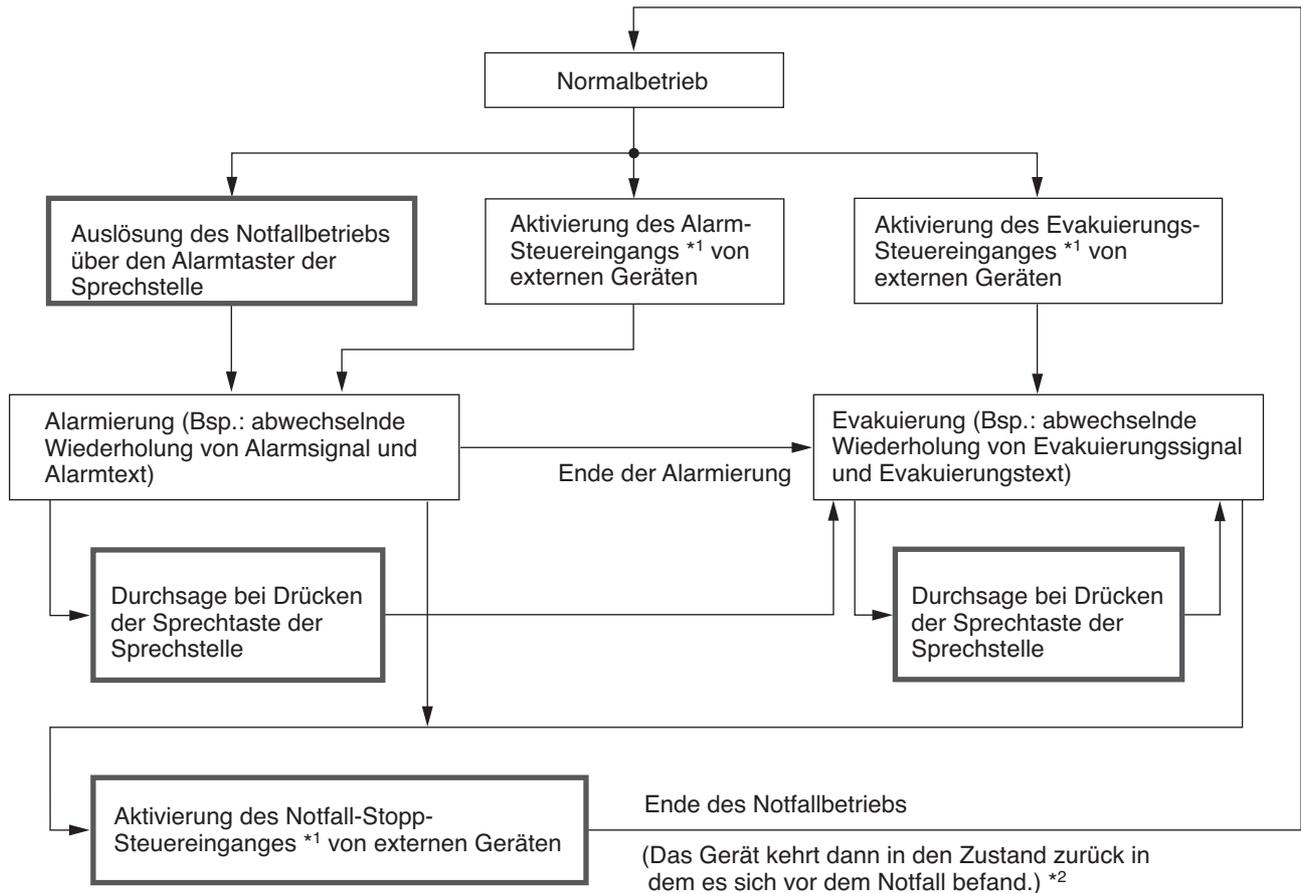
\*1 Die Steuereingänge befinden sich am Steueranschluss [CONTROL I/O] auf der Rückseite des Gerätes. Die Notfallsequenz kann auch durch Drücken der Reset-Taste auf der Frontseite beendet werden. In diesem Fall kehrt das Gerät nicht in den ursprünglichen Zustand zurück.
