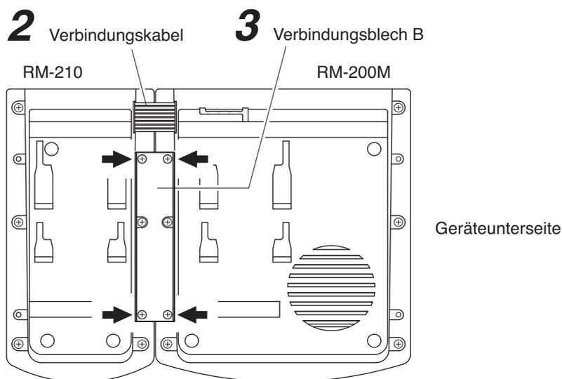
**Schritt 4.** Fixieren Sie beide Geräte mittels beider Verbindungsbleche A und je 4 vier Schrauben an den in der Zeichnung markierten Stellen [➡].
