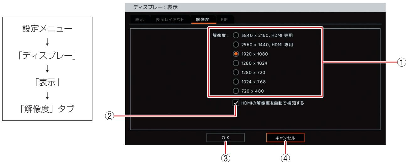
① 解像度 : 出力する解像度を設定します。
