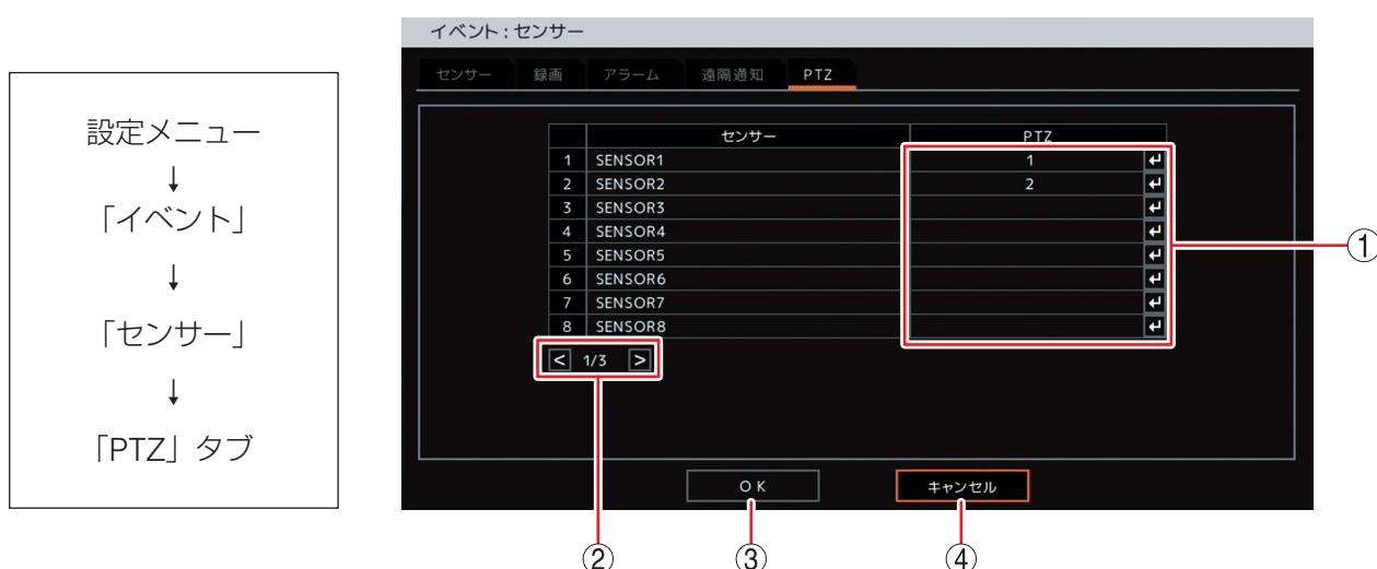
① PTZ : イベント発生時に動作するコンビネーションカメラの番号を表示します。決定キーを押すと「プリセット移動設定画面 (P. 4-90)」が表示され、動作させたいコンビネーションカメラのプリセット番号を設定できます。
