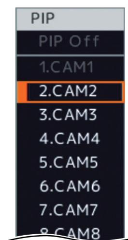
**4** PIP 表示するカメラチャンネルを選択し、決定キーを押す。
