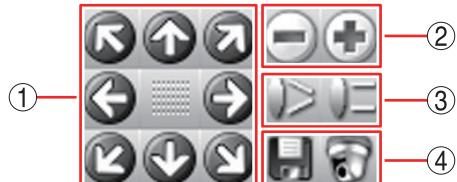
① パン・チルト：パン操作（左右）、チルト操作（上下）を行います。斜め方向の移動もできます。パン／チルトの旋回速度は、PTZ 設定で変更できます。(P. 4-42 「コンビネーションカメラ設定をする (PTZ)」)
