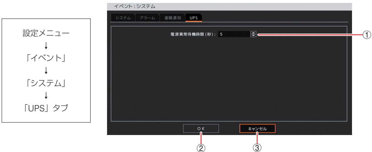
① 電源異常待機時間(秒) \* : 1 秒～36,000 秒（10 時間）から時間を設定できます。UPS から信号を受けてシャットダウンするまでの時間を設定します。決定キーを押して、上下キーで数値を変更します。
