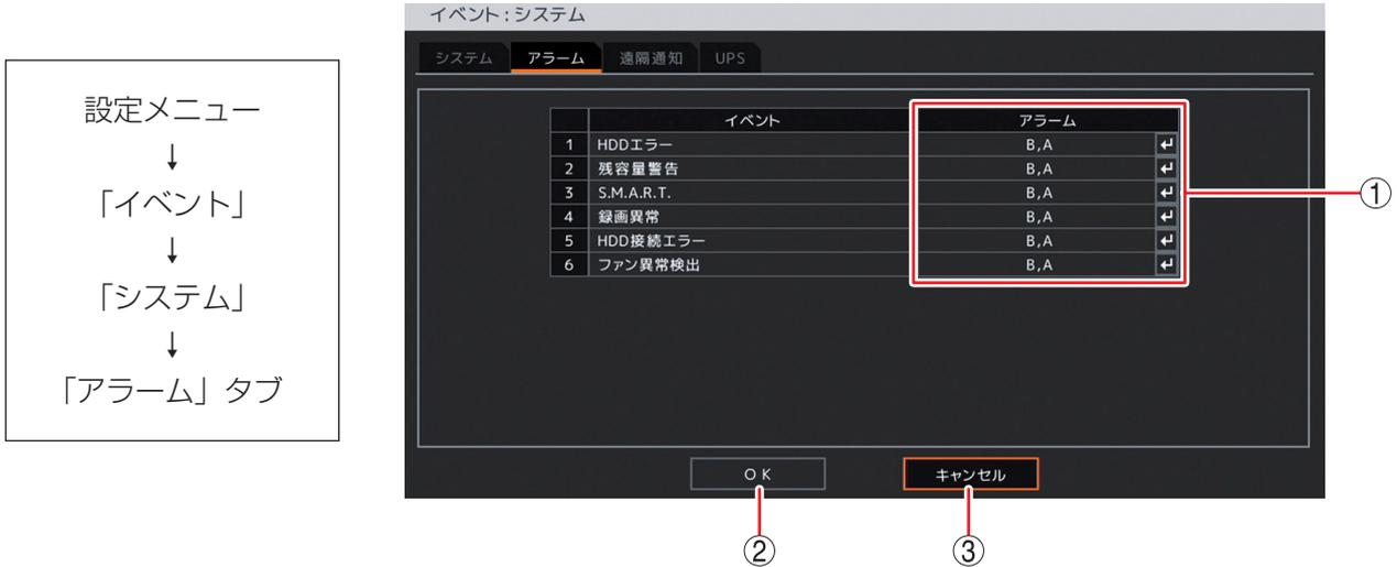
① アラーム : 以下のシステムイベントを検知したときに動作するアラームを表示します。決定キーを押すと「システムイベントアラーム選択画面（次ページ）」が表示され、アラームを設定できます。
