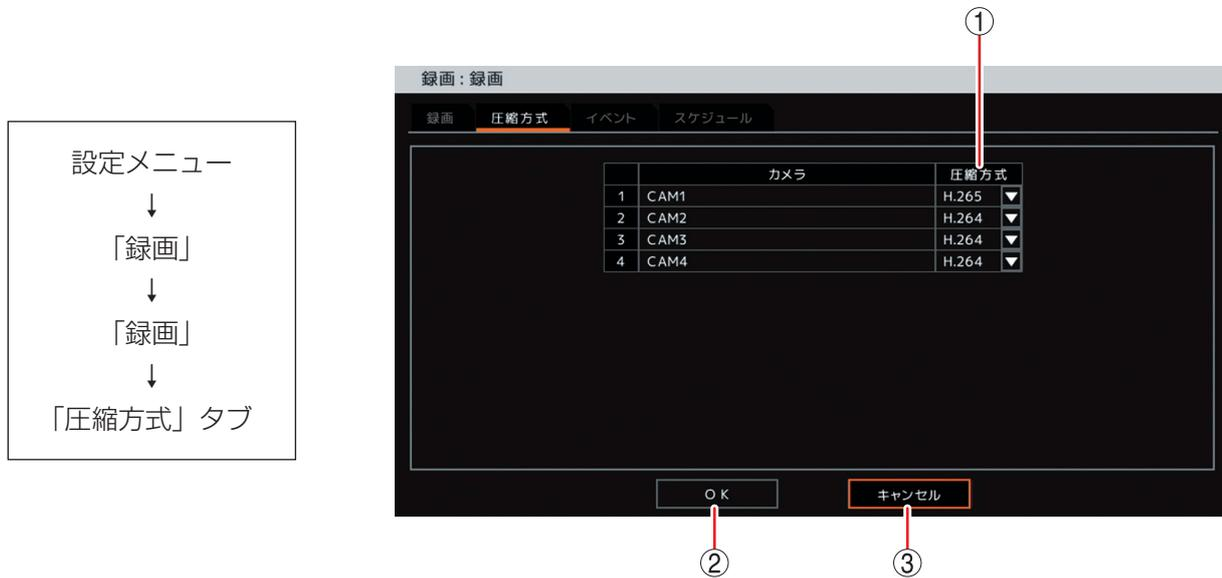
① 圧縮方式 : 画像圧縮方式を設定します。
