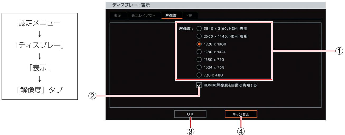
① 解像度 : 出力する解像度を設定します。
