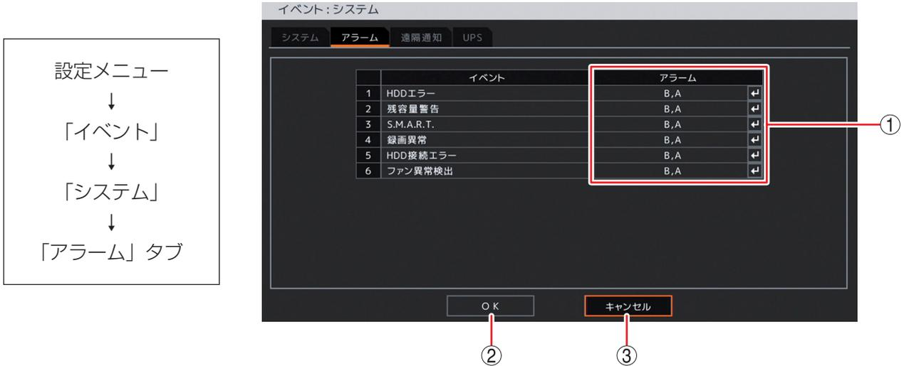
① アラーム : 以下のシステムイベントを検知したときに動作するアラームを表示します。
