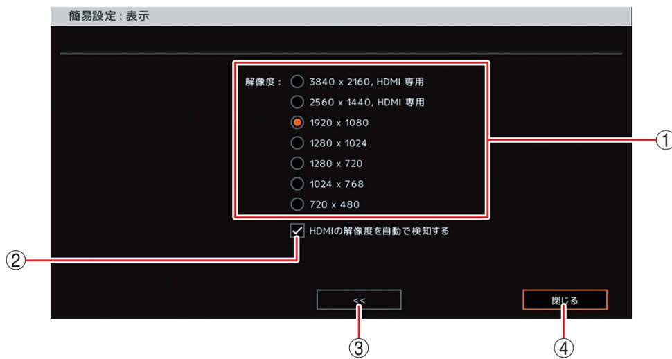
① 解像度 : 出力する解像度を設定します。
