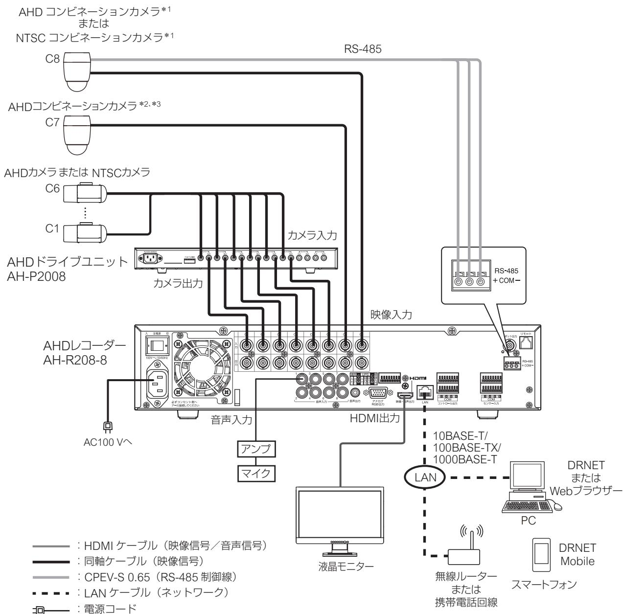
\*<sup>1</sup> コンビネーションカメラを RS-485 制御する場合の通信方式（カメラプロトコル）は、タイプ B を使用してください。また、本機の RS-485 の用途を「PTZ」、カメラのプロトコルを「TOA-B」に設定してください。（P. 4-49 「RS485 設定」、P. 4-42 「コンビネーションカメラ設定をする（PTZ）」）
