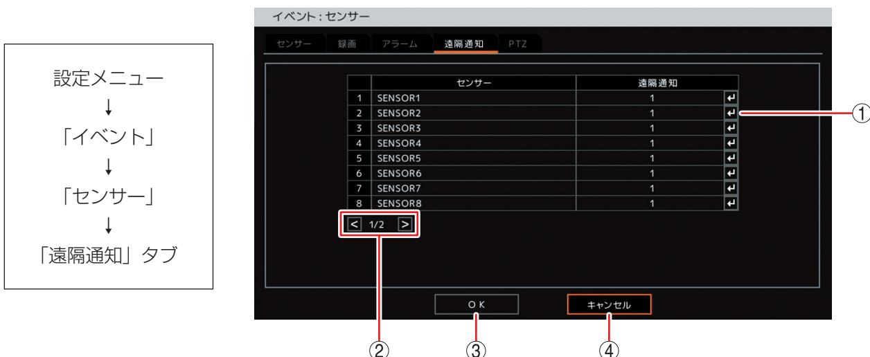
① 遠隔通知 : 該当チャンネルのセンサー入力が入ったとき、または、緊急録画を開始したときに通知するコールバックまたはメールアドレスを選択します。決定キーを押すと「通知先アドレス選択画面 (P. 4-87)」が表示されます。
