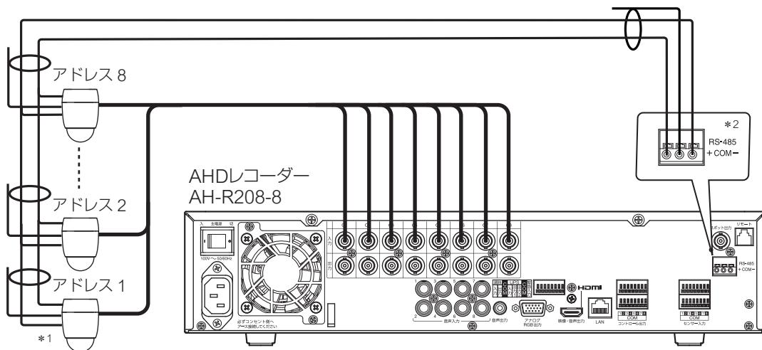
\* 1 コンビネーションカメラの終端スイッチは、正しく設定してください。詳しくは、コンビネーションカメラの取扱説明書をご覧ください。
