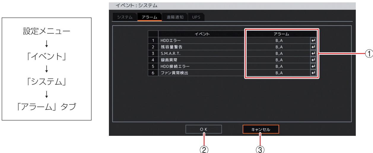
① アラーム : 以下のシステムイベントを検知したときに動作するアラームを表示します。決定キーを押すと「システムイベントアラーム選択画面 (P. 4-99)」が表示され、アラームを設定できます。
