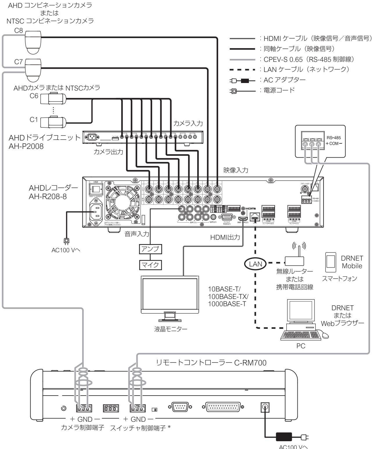
\* 本機とリモートコントローラー（C-RM700）のスイッチャ制御端子を接続して本機の画面を操作する場合は、本機のRS-485の用途を「コントローラー」に設定してください。（P. 4-49「RS485 設定」）
