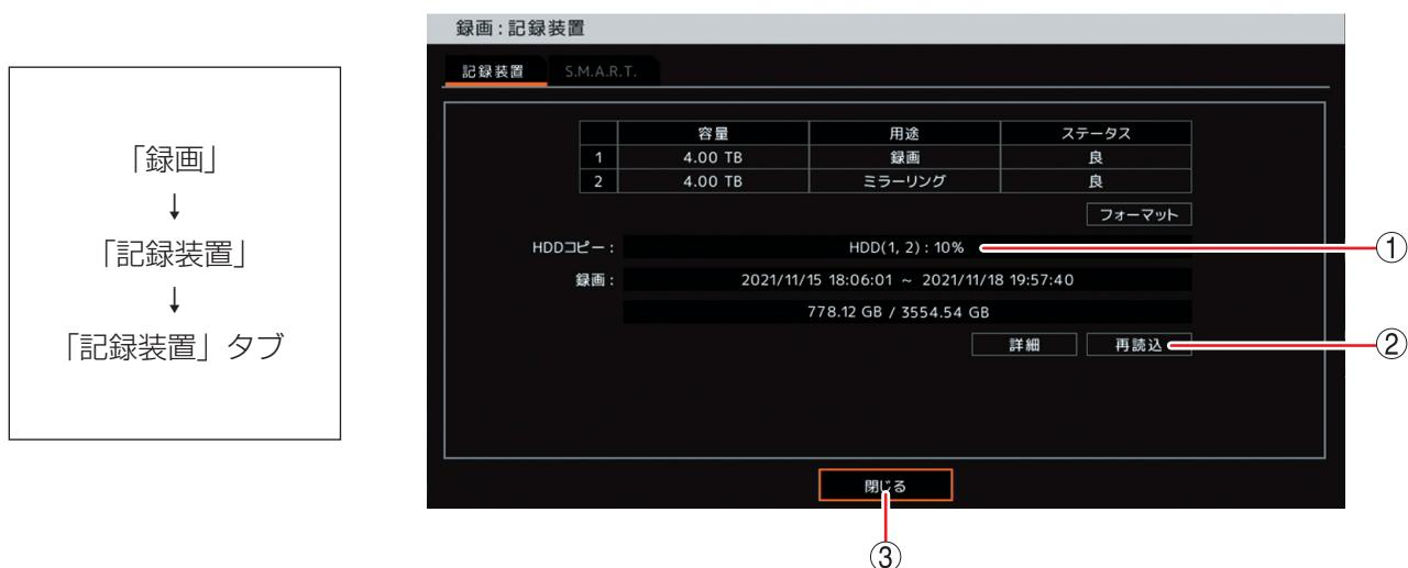
① HDD コピー : コピーの進捗状況を表示します（コピー中のみ表示）。
