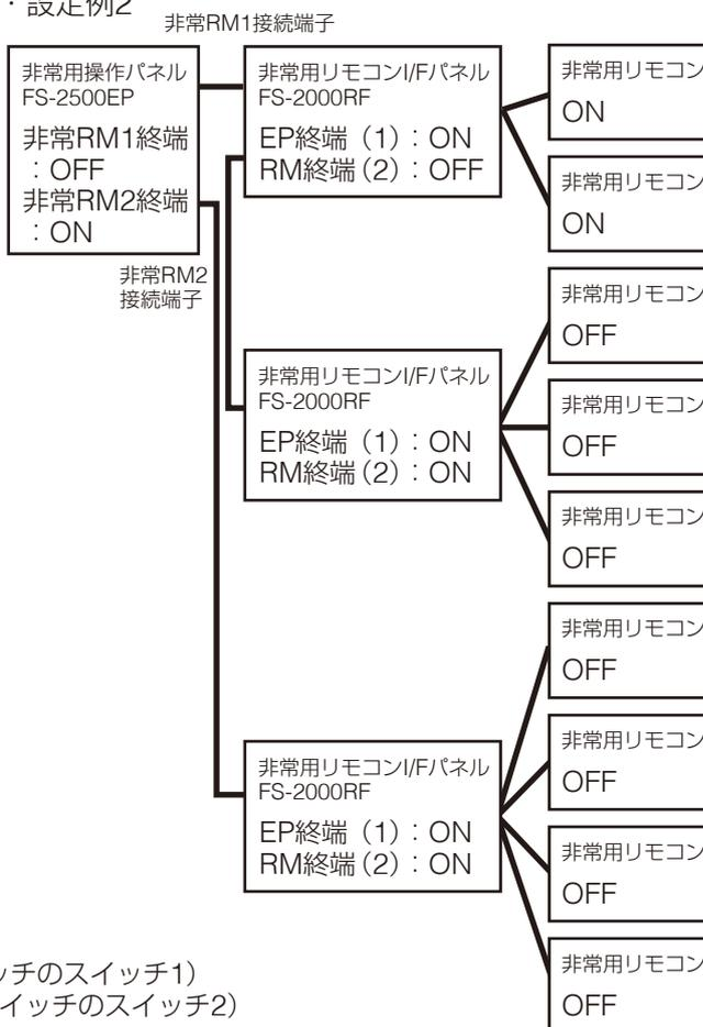
※ EP終端 (1) : FS-2500EP側終端スイッチ (設定スイッチのスイッチ1)
