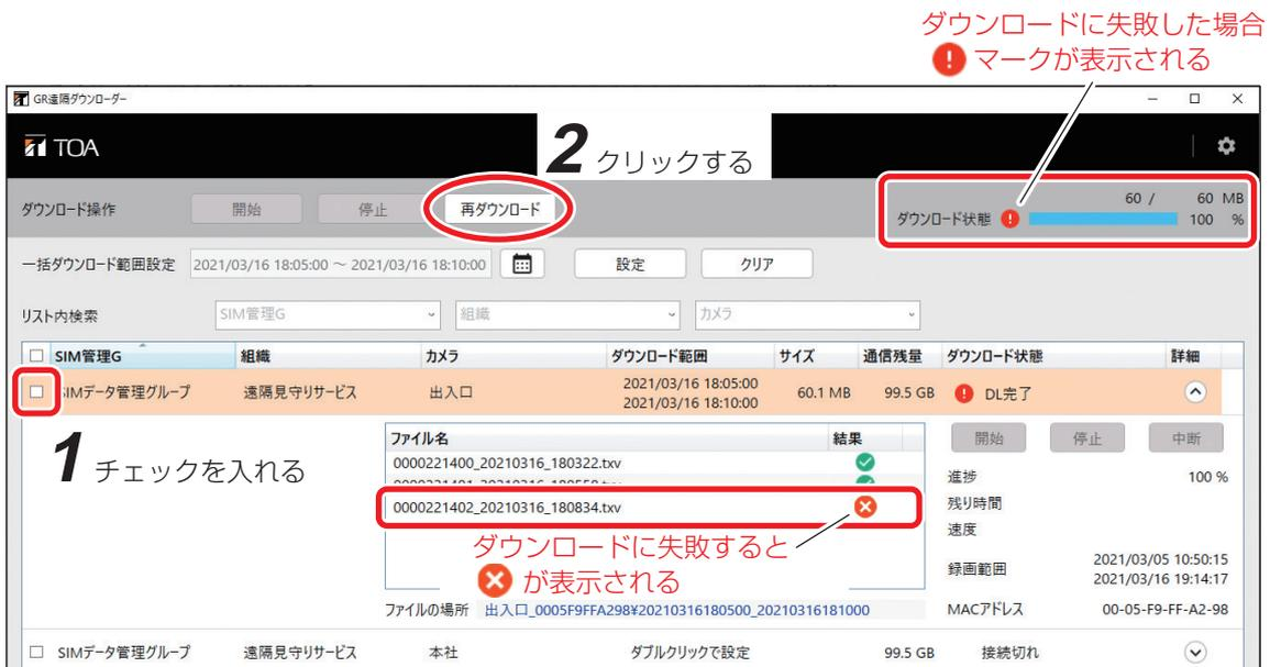
1 メイン画面の機器リストで、再ダウンロードしたい機器のチェックボックスにチェックを入れる。
