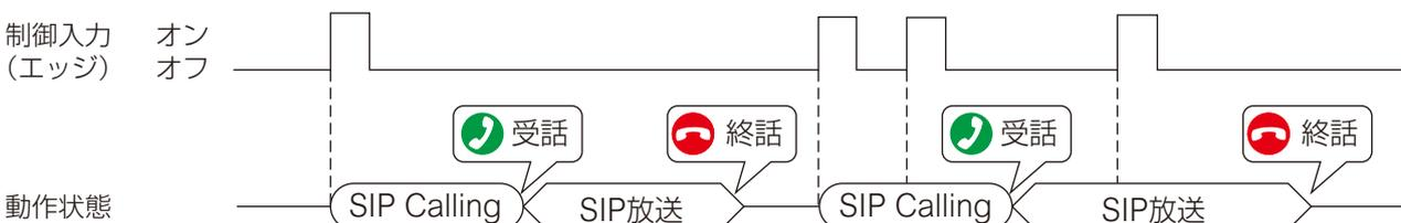
エッジ信号を検出して SIP フォンへ発呼します。発呼先の SIP フォンで受話操作を行うと、SIP 放送を開始します。SIP フォンで終話操作を行うと、SIP 放送を終了します。SIP 発呼中および SIP 放送中に同じイベントトリガーが入力されても、中断することはありません。
