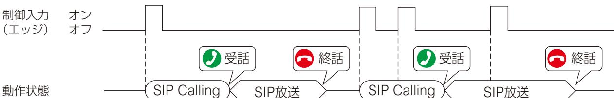
エッジ信号を検出して SIP フォンへ発呼します。発呼先の SIP フォンで受話操作を行うと、SIP 放送を開始します。SIP フォンで終話操作を行うと、SIP 放送を終了します。
