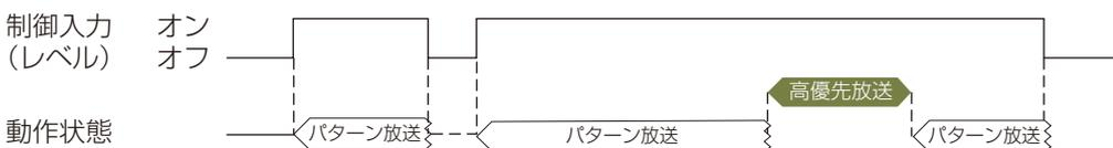
音源の長さに関係なく、レベル信号入力中は放送を継続し、パターン放送を自動的に何度も繰り返します。高優先放送により放送を中断した場合、高優先放送終了時にレベル信号が継続していれば、パターン放送を先頭から再び開始します。
