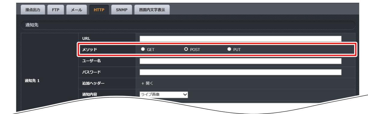
メソッドを「POST」または「PUT」を選択すると、カメラに蓄積されている検知結果を CSV ファイル形式で送信したり、現在の検知人数を JSON 形式で外部の HTTP (S) サーバーに送信したりすることができます。通知内容は以下の5つから選択できます。(工場出荷時設定：ライブ画像)
