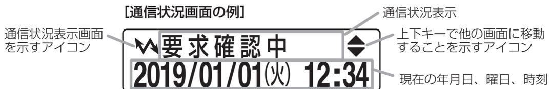
通信状況表示は、現在の通信状態によって下図のようになります。（下図では下段の表示を省略）
