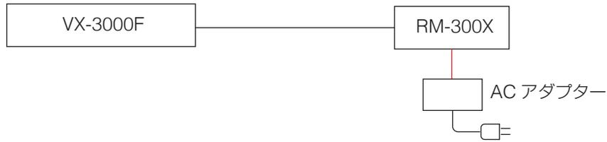
別売の AC アダプター AD-246 から STP カテゴリー 5 規格のストレートケーブルまたは 4 対以上のシールド付き CPEV 線を使用して RM-300X に電源を供給する場合、電源線を除く接続ケーブルの最長距離はケーブルの種類とリモートマイク拡張ユニットの台数に関係なく 1200 m です。
