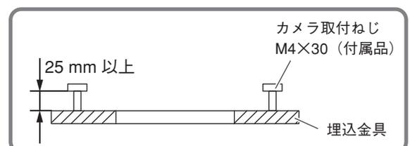
**3** 埋込金具を取付穴に固定し、埋込金具の中央から同軸ケーブルと電源ケーブルを引き出す。
