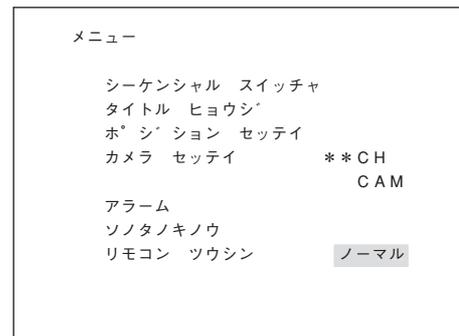
※ 構内LAN（映像ネットワークシステム）を使用し、遠隔地からリモートコントロールするリモコンは、必ず機器番号を「3（ISDN）」（リモコンディップスイッチのNo.1とNo.2がともにONの状態）にセットしてください。専用回線などにより常時接続する場合には、遠隔地からリモートできるリモコンは1台に限られます。また、構内LAN（映像ネットワークシステム）を経由しないリモコンは、機器番号が重複しないよう、必ず上記以外の機器番号に設定してください。
