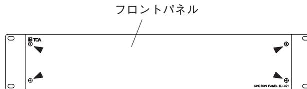
2-2. 端子台ユニットを止めているねじ 4 本 (▲印) を外し、端子台ユニットを前方に引き出します。
