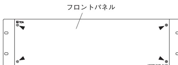
2-2. 端子台ユニットを止めているねじ4本（▲印）を外し、端子台ユニットを前方に引き出します。
