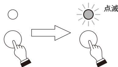
2 該当チャンネルのミュートスイッチを押し、そのチャンネルの「-40」の出力レベル表示灯が点滅したら手を離す。
