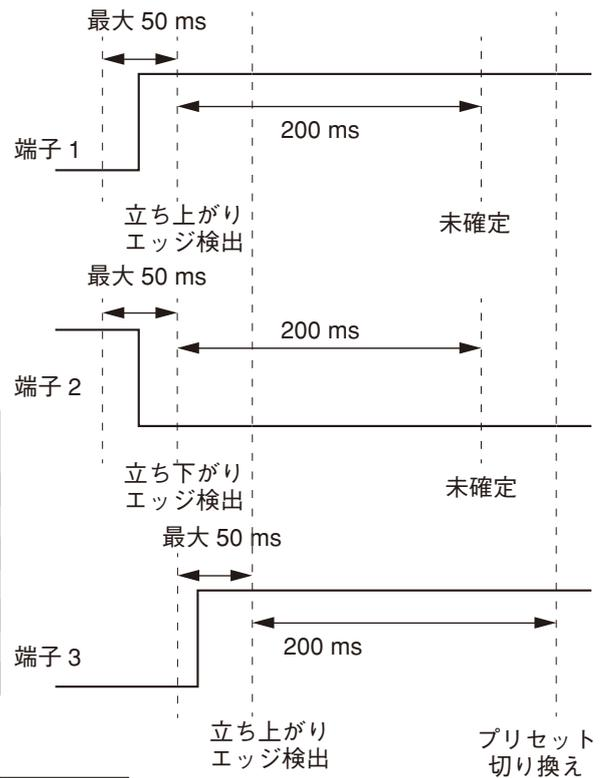
呼び出したいプリセットメモリーに相当する状態を与えて 250 ms 以上保持するとプリセットメモリーが切り換わります。次にプリセットメモリーを切り換えるまで、端子の状態は保持してください。
