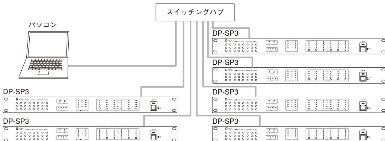
● 複数台 (最大 4 台) の DP-SP3 に対し、パソコン、接点出力機器、外部制御機器、および M-864D による制御
