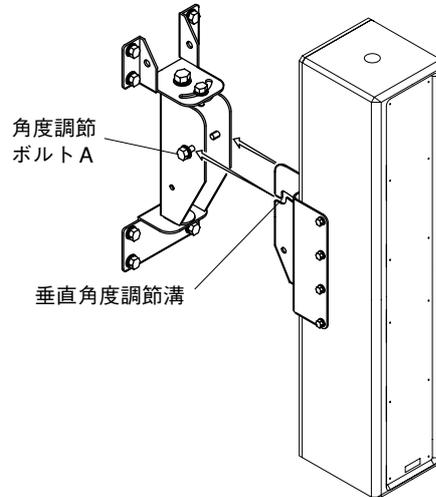
5. 2本の軸ボルトAでスピーカ金具L、Rの下側を軽く止めます。垂直方向の角度を所定の角度に合わせ、軸ボルトAと角度調節ボルトAをすべて締め付けます。
