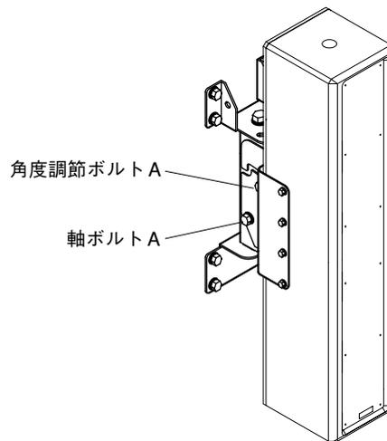
6. 上下の軸ボルトBと角度調節ボルトBを少しゆるめて水平方向の角度を調節します。所定の角度に合わせた後、上下の軸ボルトBと角度調節ボルトBをすべて締め付けてください。
