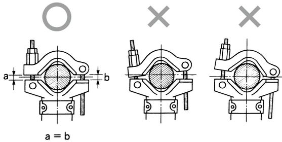
3. ブラケット A でパイプをはさみ、ロックナットとゆるみ防止ナットをしっかりと締め付けます。
