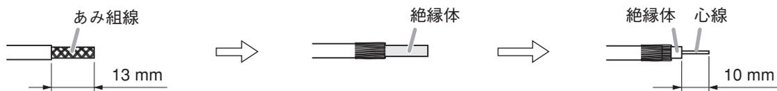
(3) 先端処理をしたケーブルを挿入し、同軸ケーブル取付ねじを、しっかりと締め付ける。
