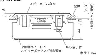
**1** スイッチボックスから配線を引き出し、スピーカー本体のねじ端子台に接続する。
