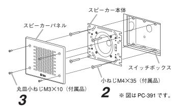
※ スイッチボックスなしで、壁に直接取り付けることもできます。その場合は、下図のように壁に穴加工をしてください。スピーカー本体を木製の壁などに取り付ける場合は、付属のタッピンねじ4×16を使用してください。
