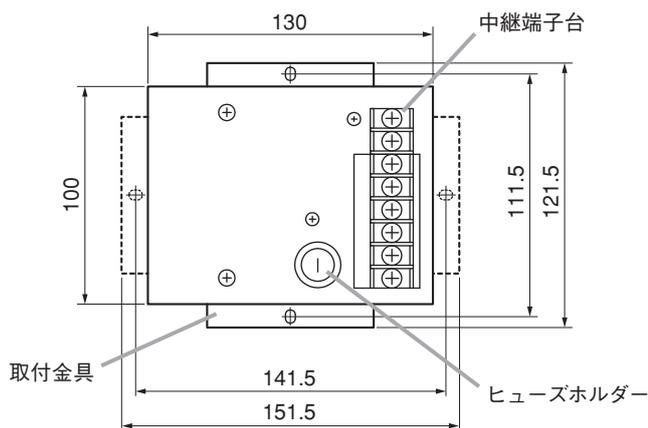
※ 付属のねじを使用してユニットを取り付けるときは、 $\phi 2.7$  mm の下穴を開けてください。
