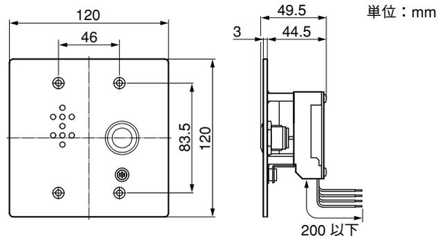
壁に取り付けた電工ボックスまたは露出ボックスにサブ端末を取り付けます。
