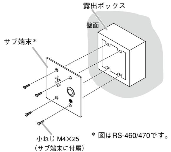
**付属ねじについて** サブ端末には、小ねじ M4 × 25 と UNC No. 6-32 × 18 の 2 種類のねじが付属されています。電工ボックスまたは露出ボックス側がミリねじの場合は、小ねじ M4 × 25 をご使用ください。
