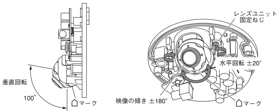
**4** レンズユニット固定ねじを締めて角度を固定する。
