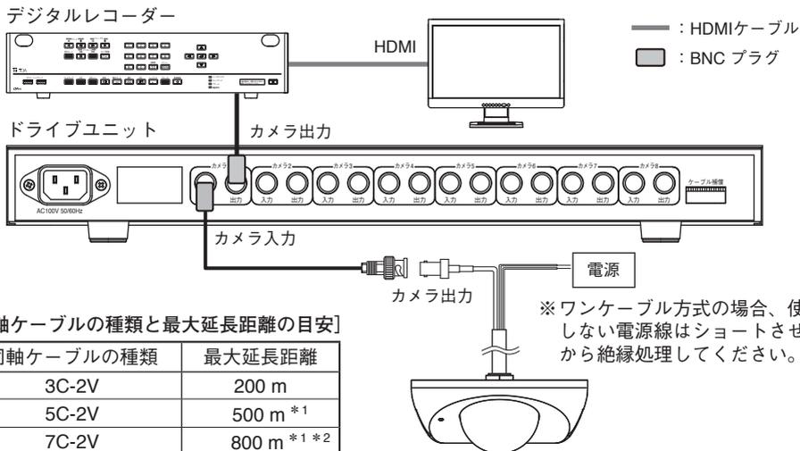
[同軸ケーブルの種類と最大延長距離の目安]
