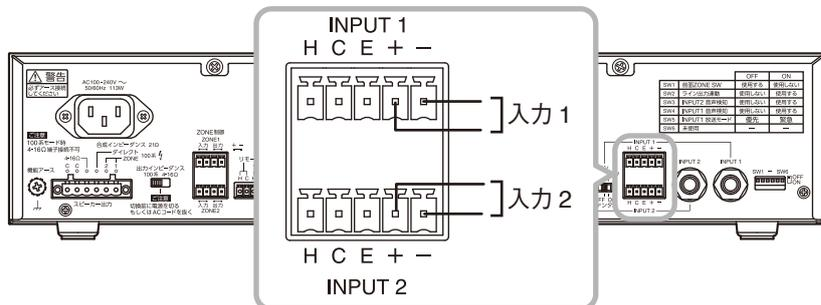
入力信号仕様：短絡電流：10 mA 以下、開放電圧：DC35 V 以下
