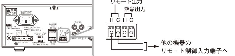
出力仕様：オープンコレクター出力、耐電圧 DC30 V 以下、電流 25 mA 以下
