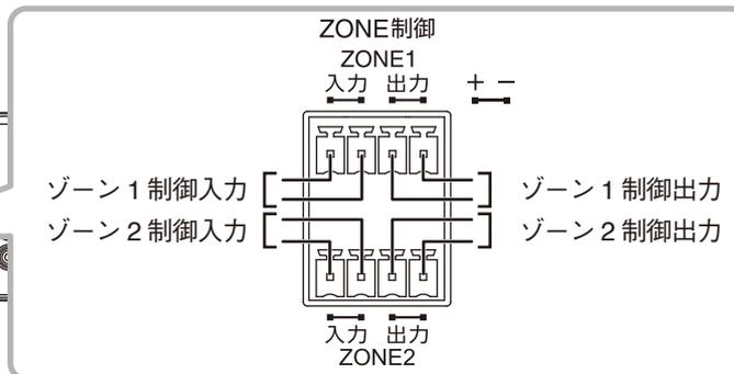
制御入力信号仕様：短絡電流：10 mA 以下、開放電圧：DC 35 V 以下
