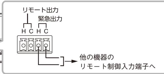
出力仕様：オープンコレクター出力、耐電圧 DC30 V 以下、電流 25 mA 以下
