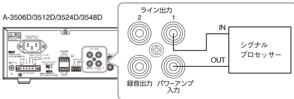
ライン出力仕様：0 dB \*、600 Ω、不平衡、RCA ピンジャック
