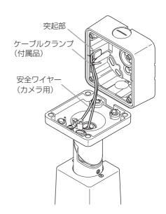
**2** カメラを吊り下げた状態でケーブルを接続し、接続部を防水処置する。
