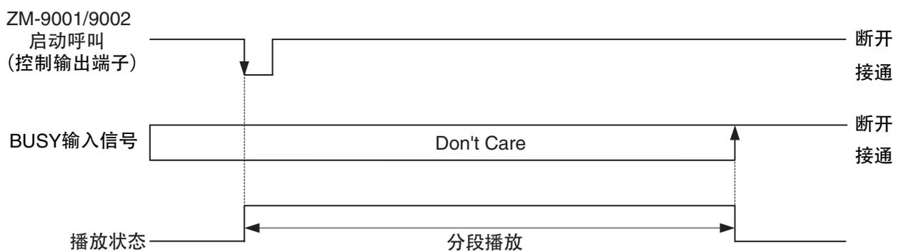
呼叫的启动可按下ZM-9001/9002的前侧面板的按钮触发。（不论BUSY输入设为闭合/断开。）
