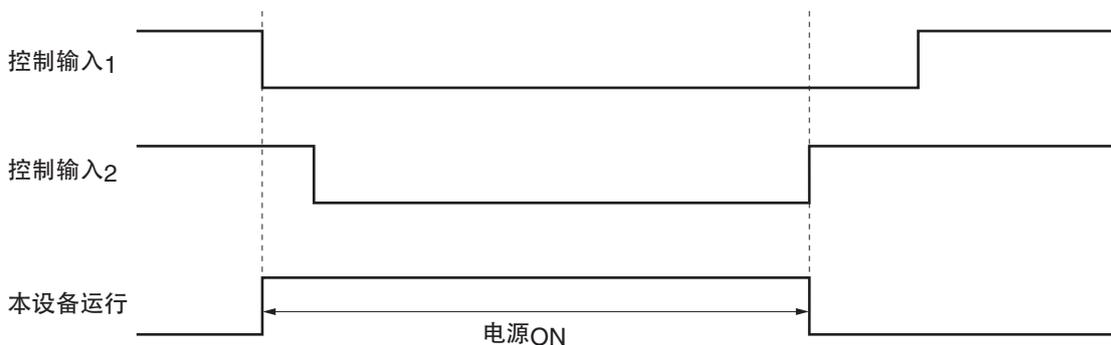
控制输入2设为OFF后, 从控制输入1上看电源为ON, 但本设备电源已处于OFF状态。
